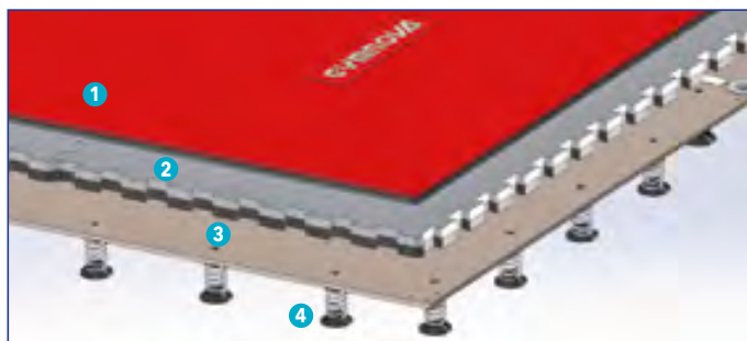
1) Rollbahnen - 2) Schaumstoffplatten in „Puzzle“-Form 3) Schwingbodenelemente - 4) Federn
