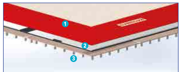
1/ Päällysmatto – 2/ Haitarimallinen joustopehmuste – 3/ Dynaamiset solumuovikuutiot
