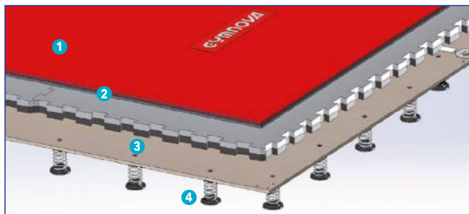
1/ Rolmatten - 2/ Puzzelvormige moussepanelen 3/ Dynamische plankenvloer - 4/ Veren.
