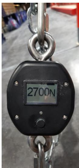
Facile à utiliser grâce à sa touche de prise de mesure et son affichage numérique, ce tensiomètre **permettra aux gymnastes d'adapter la tension des câbles de l'agres en fonction de leurs besoins** en compétition comme en entraînement.
